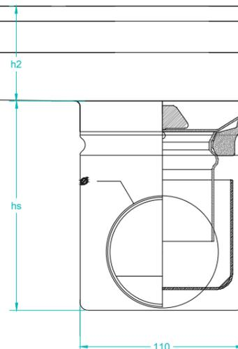
Canal de cocina INZA realizado íntegramente en acero inoxidable AISI304/316L con sistema "concave angle" para evitar sedimentación de residuos en las esquinas.
