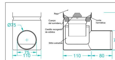
ejemplo de salida DN75 vertical y horizontal
